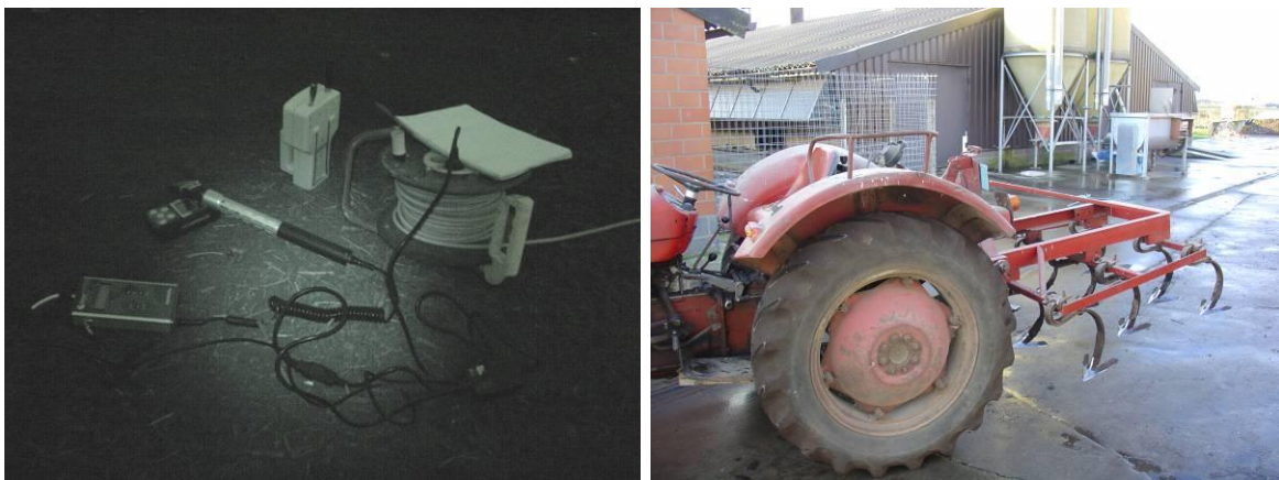
Figuur 6. Links: apparatuur om het stalklimaat in kaart te brengen. Rechts: de cultivator waarmee het compostsubstraat opengetrokken werd, met op de achtergrond de toegangspoort tot de stal.
