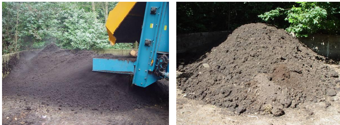
Figuur 7. Opzet van de hoop, waarbij mest en groencompost gemengd en afgedraaid worden.
