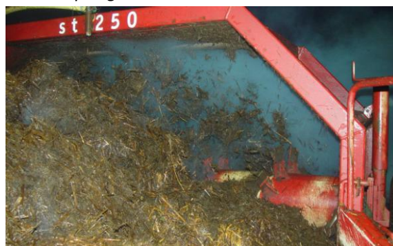
Figuur 10. Eerste omzet geitenstalmest met een Sandberger compostkeerder: het keren van de sterk samengeklitte geitenstalmest verliep erg moeizaam.
