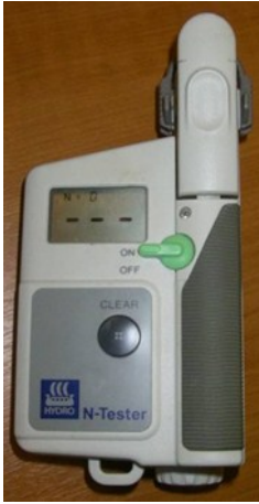
Figuur 2 - Met dit toestel kan je het chlorofylgehalte in het blad meten. Dit toestel kan bijvoorbeeld worden gebruikt voor stikstofbijbemesting in aardappelen.
