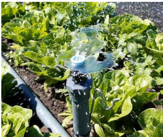
Afbeelding 3. De microsprinklers sproeien continu de volledige 360° rond.
